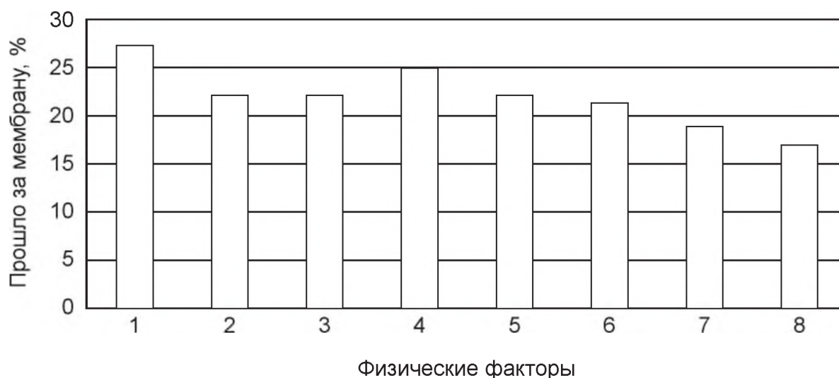
Рис. 11. Действие различных физических факторов на форетическую подвижность карбохромена в различных физических полях (экспозиция 5 мин): 1 – излучение гелий-неонового лазера ( \lambda = 633 нм, 20 мВт); 2 – коротковолновое ультрафиолетовое излучение (254 нм, мощность лампы 220 Вт); 3 – ультразвук (0,88 МГц, 0,6 Вт/см 2 ); 4 – ЭМИ 460 МГц, 2 Вт; 5 – ЭМИ 40,7 МГц, 15 Вт; 6 – переменное магнитное поле (50 Гц, 35 мТл); 7 – постоянное магнитное поле (30 мТл); 8 – постоянный электрический ток (электрофорез) (Миненков А.А., 1989; Москвин С.В., Миненков А.А., 2012)
